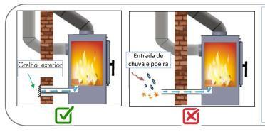
A entrada de ar exterior permite que o ar limpo entre diretamente na câmara de combustão. A sua utilização é obrigatória no caso de casas passivas (muito herméticas). Se não estiver a ser utilizado, deve ser deixado um mínimo de 10 cm entre o bocal de entrada de ar e a parede traseira para que o dispositivo funcione corretamente
