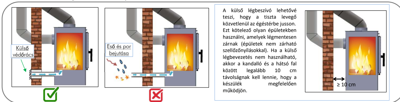
7°.- Külső légbeszívó beépítése
